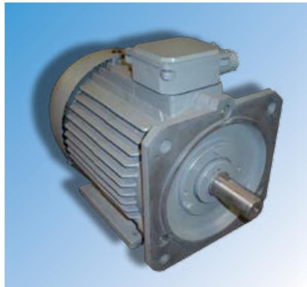
Трёхфазный асинхронный двухскоростной двигатель с короткозамкнутым ротором мощностью 5,5/11,0 кВт и синхронной частотой вращения 3000/6000 об/мин предназначен для привода специального изделия.
