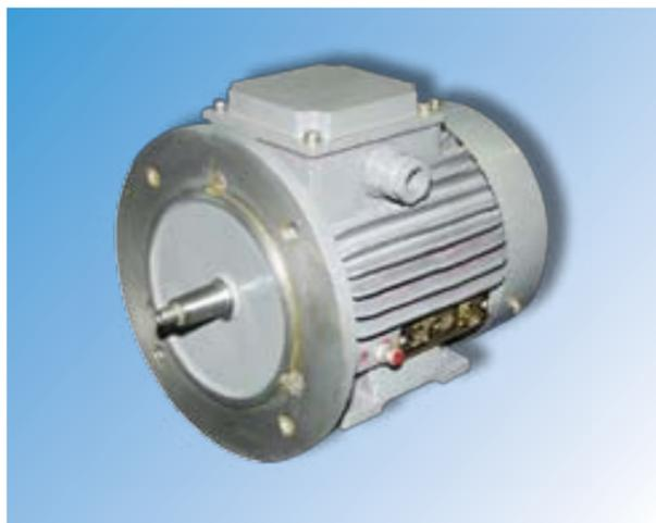
Трёхфазный асинхронный двигатель с короткозамкнутым ротором мощностью 0,75 кВт предназначен для привода центробежных вентиляторов электровозов. Питание двигателя – от преобразователя частоты с широтно-импульсной модуляцией напряжением 380 В и частотой 50 Гц. Режим работы двигателей – продолжительный. Двигатели соответствуют условиям эксплуатации в части воздействия механических факторов группе М25 по ГОСТ 17516.1. Ресурс двигателя до капитального ремонта – 72000 ч, срок службы – 33 года.
