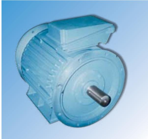
Асинхронные трёхфазные двухскоростные двигатели с короткозамкнутым ротором типа 5АТ160, 180 и 225 предназначены для привода механизмов подъёма и передвижения кранов различного назначения. Мощность двигателей от 5,5 кВт до 37 кВт; соотношение скоростей 3:1 и 4:1. Двигатели имеют две независимые обмотки на статоре, что позволяет получить благоприятные механические характеристики на различных скоростях. Перегрузочная способность – более 2,5.
