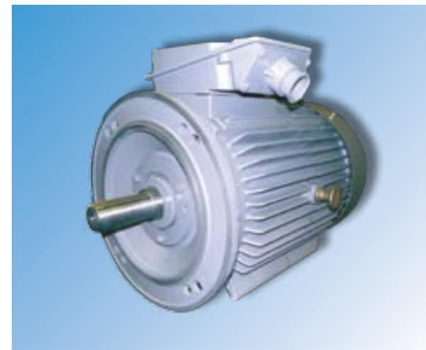
Трёхфазные асинхронные двигатели с короткозамкнутым ротором в специальном исполнении А112М4ЖНДУ5, А160S2ЖНДУ5, А225М2ЖНДУ4, А250S2ЖНДУ5, А250М2ЖНДУ4, А355М4ЖНДУ4–1 предназначены для привода центробежных многоступенчатых секционных электронасосных агрегатов специального назначения. Питание двигателей осуществляется от сети трёхфазного переменного тока напряжением 380 В, частотой 50 Гц. Режим работы двигателей – продолжительный.
